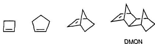
Schema 18. Cyclische Olefine, die Kaminsky und Mitarbeiter [207] bei Ring-erhaltenden Polymerisationsreaktionen mit \text{rac-C}_2\text{H}_4(\text{ind})_2\text{ZrCl}_2/\text{MAO} oder \text{rac-Me}_2\text{Si}(\text{ind})_2\text{ZrCl}_2/\text{MAO} umsetzen konnten.
